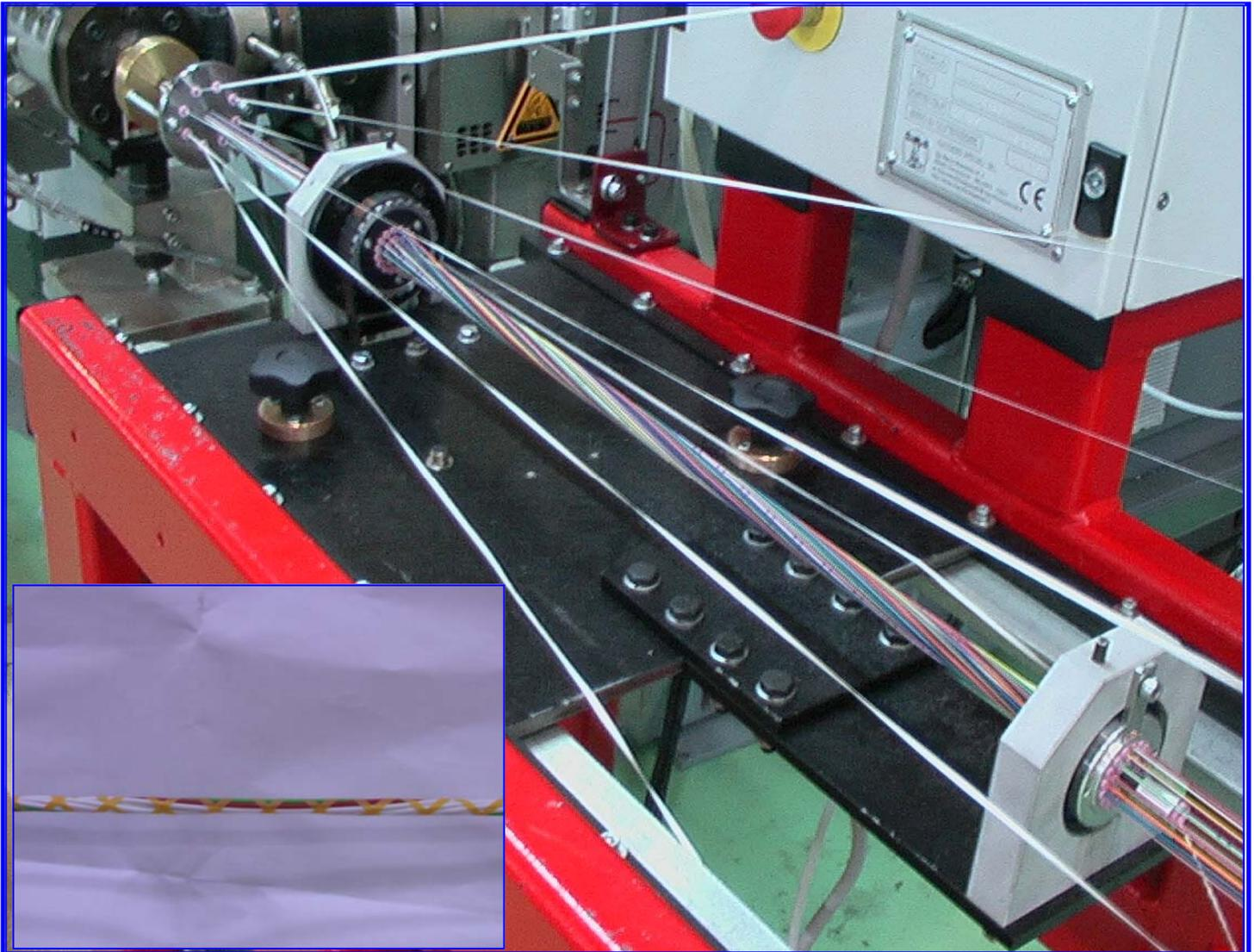
**Diese Vorrichtung ist geeignet fuer die SZ-Verseilung von Mikrokabel, bestehend aus tightgecoateten Fasern oder aus konventionellen Leiter .**
